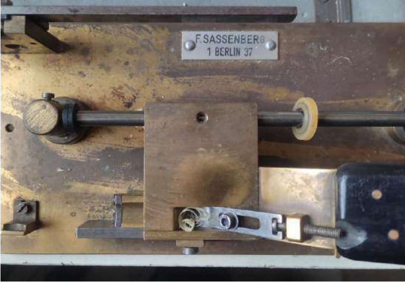
Resim 30: Obua Sanatçısı Altan Sertel'e Ait Olan Aydın Yaşar Acar'a Bıraktığı F.Sassenberg Marka Alman Yapım Obua Kamış İç Kazıma Makinesi (İstanbul) (Kaynak: Aydın Yaşar Acar Arşivinden)
