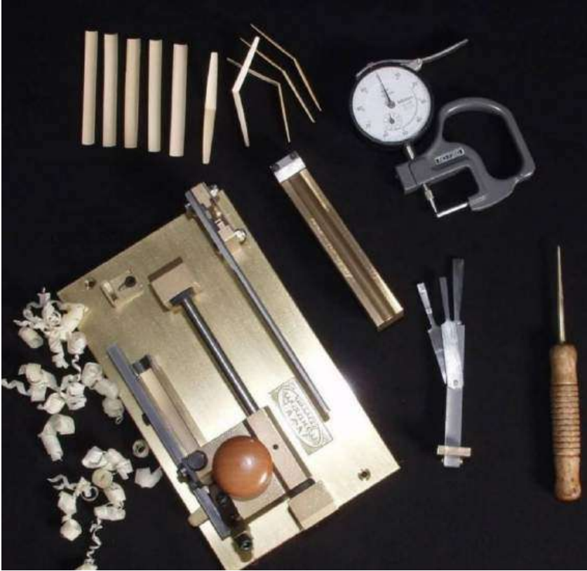
Resim 131: Aydın Yaşar Acar’ın Kendi İmalatı Olan Obua Kâmiş İç Oyma Makinesi (Kaynak: Aydın Yaşar Acar Arşivinden)
